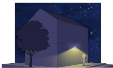
Éclairage bon : le flux lumineux est dirigé vers le bas et aucun flux n'est émis au-dessus du plan horizontal. La pollution lumineuse est limitée.
